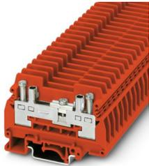
Morsetto sezionatore, tensione nominale: 400 V, corrente nominale: 41 A, tipo di connessione: Connessione a vite, 1. piano, Sezione di dimensionamento: 6 mm<sup>2</sup>, sezione: 0,5 mm<sup>2</sup> - 10 mm<sup>2</sup>, tipo di montaggio: NS 35/7,5, NS 35/15, NS 32, colore: rosso
