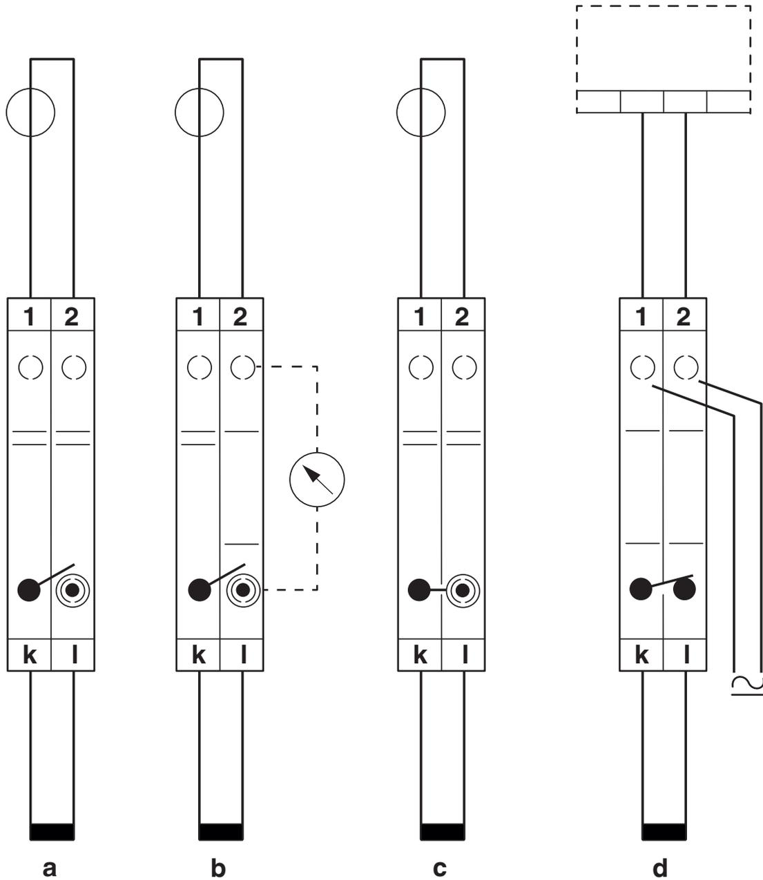
Collegamento di prova convertitore di corrente semplice
