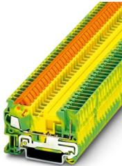
Morsetti comp. per conduttori terra, numero di connessioni: 2, tipo di connessione: Connessione rapida/a innesto, 1. Piano attacco sinistra, sezione: 0,25 mm<sup>2</sup> - 1,5 mm<sup>2</sup>, 1. piano, collegamento a destra, tipo di montaggio: NS 35/7,5, NS 35/15, colore: giallo-verde
