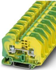
Morsetti comp. per conduttori terra, Attenzione: per i capocorda non isolati impiegare l'estensione di linee BE-RT... (vedere accessori)!, tensione nominale: 1000 V, corrente nominale: 24 A, numero di connessioni: 2, tipo di connessione: Bullone, tipo di montaggio: NS 35/7,5, NS 35/15, colore: giallo-verde
