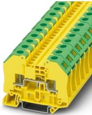
Morsetti comp. per conduttori terra, Attenzione: per i capocorda non isolati impiegare l'estensione di linee BE-RT... (vedere accessori)!, tensione nominale: 1000 V, corrente nominale: 24 A, numero di connessioni: 2, tipo di connessione: Bullone, 1. piano, Sezione di dimensionamento: 2,5 mm<sup>2</sup>, tipo di montaggio: NS 35/7,5, NS 35/15, colore: giallo-verde
