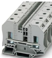
Morsetto di collegamento a bullone, tensione nominale: 1000 V, corrente nominale: 125 A, numero di connessioni: 2, numero poli: 1, tipo di connessione: Bullone, Sezione di dimensionamento: 35 mm<sup>2</sup>, tipo di montaggio: NS 35/7,5, NS 35/15, colore: grigio
