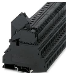
Morsetto portafusibili, tipo di fusibile: Vetro / ceramica / ..., tipo fusibile: G / 5 x 20, tensione nominale: 24 V, corrente nominale: 6,3 A, tipo di connessione: Connessione a vite, sezione: 0,2 mm<sup>2</sup>- 4 mm<sup>2</sup>, Sezione di dimensionamento: 1,5 mm<sup>2</sup>, tipo di montaggio: NS 35/7,5, NS 35/15, NS 32, colore: nero
