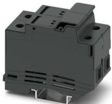
Morsetto portafusibili, tipo di fusibile: Vetro / ceramica / ..., tipo fusibile: Class CC, tensione nominale: 600 V, corrente nominale: 30 A, numero poli: 2, tipo di connessione: Connessione a vite, Sezione di dimensionamento: 16 mm<sup>2</sup>, sezione: 1 mm<sup>2</sup>- 16 mm<sup>2</sup>, tipo di montaggio: NS 35/7,5, NS 35/15, colore: nero
