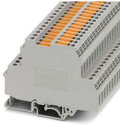
Morsetto passante, tensione nominale: 400 V, corrente nominale: 10 A, 1. e 2. piano, tipo di connessione: Connessione a vite, Sezione di dimensionamento: 4 mm<sup>2</sup>, sezione: 0,2 mm<sup>2</sup> - 4 mm<sup>2</sup>, 2. piano, tipo di connessione: Connessione a vite, Sezione di dimensionamento: 4 mm<sup>2</sup>, sezione: 0,2 mm<sup>2</sup> - 4 mm<sup>2</sup>, montaggio: NS 35/7,5, NS 35/15, NS 32, colore: grigio
