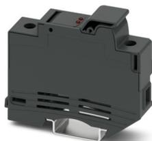
Morsetto portafusibili, tipo di fusibile: Vetro / ceramica / ..., tipo fusibile: 10,3 x 38 mm, tensione nominale: 1000 V AC, corrente nominale: 32 A, numero poli: 1, tipo di connessione: Connessione a vite, Sezione di dimensionamento: 16 mm<sup>2</sup>, sezione: 1,5 mm<sup>2</sup>- 25 mm<sup>2</sup>, tipo di montaggio: NS 35/7,5, NS 35/15, colore: nero
