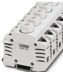
Morsetto portafusibili, tipo di fusibile: Cartuccia a vite, tipo fusibile: D 02 / E 18, tensione nominale: 400 V, corrente nominale: 63 A, tipo di connessione: Connessione a vite, Sezione di dimensionamento: 35 mm<sup>2</sup>, sezione: 1,5 mm<sup>2</sup>- 35 mm<sup>2</sup>, tipo di montaggio: NS 35/7,5, NS 35/15, colore: grigio chiaro
