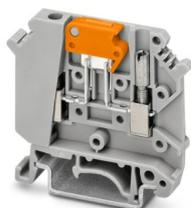
Morsetto con sezionatore a coltello, con viti per prese di prova per l'alloggiamento di spine di prova, tensione nominale: 500 V, corrente nominale: 16 A, 1. piano, tipo di connessione: Connessione a vite, Sezione di dimensionamento: 2,5 mm<sup>2</sup>, sezione: 0,2 mm<sup>2</sup> - 6 mm<sup>2</sup>, montaggio: NS 32, NS 35/7,5, NS 35/15, colore: rosso
