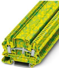
Morsetti comp. per conduttori terra, numero di connessioni: 2, tipo di connessione: Connessione a vite, sezione: 0,14 mm<sup>2</sup> - 6 mm<sup>2</sup>, tipo di montaggio: NS 35/7,5, NS 35/15, colore: giallo-verde
