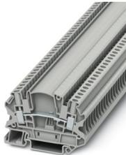
Morsetto passante, tensione nominale: 500 V, corrente nominale: 32 A, numero di connessioni: 2, tipo di connessione: Connessione a vite, sezione: 0,14 mm<sup>2</sup> - 6 mm<sup>2</sup>, tipo di montaggio: NS 35/7,5, NS 35/15, colore: grigio
