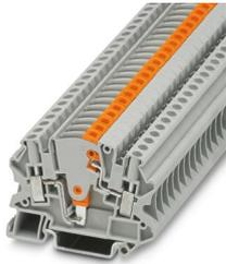
Morsetto sezionatore per conv. misura, con viti per prese di prova per l'alloggiamento di spine di prova, tensione nominale: 500 V, corrente nominale: 28 A, numero di connessioni: 2, tipo di connessione: Connessione a vite, Sezione di dimensionamento: 4 mm<sup>2</sup>, sezione: 0,14 mm<sup>2</sup> - 6 mm<sup>2</sup>, tipo di montaggio: NS 35/7,5, NS 35/15, colore: grigio
