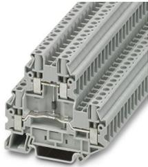
Componente morsetto componibile, con diodo integrato 1N4007, corrente nominale: 0,5 A, tipo di connessione: Connessione a vite, Sezione di dimensionamento: 4 mm<sup>2</sup>, sezione: 0,14 mm<sup>2</sup> - 6 mm<sup>2</sup>, tipo di montaggio: NS 35/7,5, NS 35/15, colore: grigio
