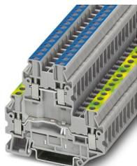
Morsetto a due piani per conduttori di terra, tensione nominale: 500 V, corrente nominale: 24 A, tipo di connessione: Connessione a vite, Sezione di dimensionamento: 2,5 mm<sup>2</sup>, sezione: 0,14 mm<sup>2</sup> - 4 mm<sup>2</sup>, tipo di montaggio: NS 35/7,5, NS 35/15, colore: grigio
