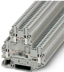
Componente morsetto componibile, La corrente massima è determinata dal diodo. Integrato: diodo 1N 4007, tensione di blocco: 1300V, corrente limite permanente: 0,5A., con diodo integrato, tensione nominale: 500 V, corrente nominale: 0,5 A, tipo di connessione: Connessione a vite, 1. e 2. piano, Sezione di dimensionamento: 2,5 mm<sup>2</sup>, sezione: 0,14 mm<sup>2</sup> - 4 mm<sup>2</sup>, tipo di montaggio: NS 35/7,5, NS 35/15, colore: grigio
