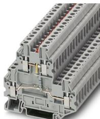
Componente morsetto componibile, La tensione è determinata dal tipo di LED scelto., tensione nominale: 24 V, corrente nominale: 24 A, tipo di connessione: Connessione a vite, Sezione di dimensionamento: 2,5 mm<sup>2</sup>, sezione: 0,14 mm<sup>2</sup> - 4 mm<sup>2</sup>, tipo di montaggio: NS 35/7,5, NS 35/15, colore: grigio
