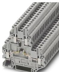
Componente morsetto componibile, La corrente massima è determinata dal diodo. Integrato: diodo 1300 V 1 A, tensione di blocco: 1300 V, corrente limite permanente: 0,5 A., con diodo integrato, corrente nominale: 0,5 A, tipo di connessione: Connessione a vite, 1. e 2. piano, Sezione di dimensionamento: 2,5 mm<sup>2</sup>, sezione: 0,14 mm<sup>2</sup> - 4 mm<sup>2</sup>, tipo di montaggio: NS 35/7,5, NS 35/15, colore: grigio
