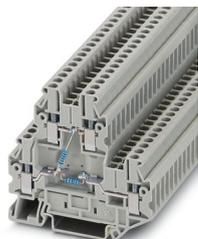
Componente morsetto componibile, tipo di connessione: Connessione a vite, 1. e 2. piano, Sezione di dimensionamento: 2,5 mm<sup>2</sup>, sezione: 0,14 mm<sup>2</sup> - 4 mm<sup>2</sup>, tipo di montaggio: NS 35/7,5, NS 35/15, colore: grigio
