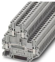
Componente morsetto componibile, La corrente massima è determinata dal diodo. Integrato: diodo 1N 4007, tensione di blocco: 1300V, corrente limite permanente: 0,5A., con diodo integrato, corrente nominale: 0,5 A, tipo di connessione: Connessione a vite, 1. e 2. piano, Sezione di dimensionamento: 2,5 mm<sup>2</sup>, sezione: 0,14 mm<sup>2</sup> - 4 mm<sup>2</sup>, tipo di montaggio: NS 35/7,5, NS 35/15, colore: grigio
