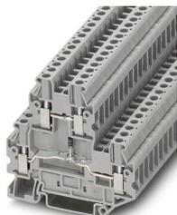
Componente morsetto componibile, La corrente massima è determinata dal diodo. Integrato: diodo 1N 4007, tensione di blocco: 1300V, corrente limite permanente: 0,5A., con diodo integrato, corrente nominale: 0,5 A, tipo di connessione: Connessione a vite, 1. e 2. piano, Sezione di dimensionamento: 2,5 mm<sup>2</sup>, sezione: 0,14 mm<sup>2</sup> - 4 mm<sup>2</sup>, tipo di montaggio: NS 35/7,5, NS 35/15, colore: grigio
