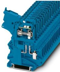
Morsetto portafusibili, tipo di fusibile: Vetro / ceramica / ..., tipo fusibile: G / 5 x 20, tensione nominale: 24 V, corrente nominale: 6,3 A, tipo di connessione: Connessione a vite, Sezione di dimensionamento: 4 mm<sup>2</sup>, sezione: 0,14 mm<sup>2</sup>- 6 mm<sup>2</sup>, tipo di montaggio: NS 35/7,5, NS 35/15, colore: blu
