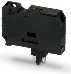
Spina portafusibile, Prima di sostituire il fusibile G, estrarre la spina portafusibile dal morsetto base., tensione nominale: 500 V, corrente nominale: 10 A, tipo di connessione: Attacco connettore, tipo fusibile: G / 6,3 x 32, colore: nero
