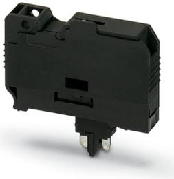
Spina portafusibile, Prima di sostituire il fusibile G, estrarre la spina portafusibile dal morsetto base., tensione nominale: 630 V, corrente nominale: 10 A, tipo di connessione: Attacco connettore, tipo fusibile: G / 6,3 x 32, tipo di montaggio: Montaggio a innesto, colore: nero
