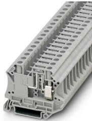
Morsetto sezionatore, Corrente e tensione sono determinate dalla spina impiegata., tensione nominale: 500 V, corrente nominale: 20 A, tipo di connessione: Connessione a vite, Sezione di dimensionamento: 6 mm<sup>2</sup>, sezione: 0,2 mm<sup>2</sup> - 10 mm<sup>2</sup>, montaggio: NS 35/7,5, NS 35/15, colore: grigio
