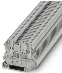
Morsetto sezionatore, Corrente e tensione sono determinate dalla spina impiegata., con viti per prese di prova per l'alloggiamento di spine di prova, tensione nominale: 400 V, Corrente continua termica  $I_{th}$ : 20 A, tipo di connessione: Connessione a vite, Sezione di dimensionamento: 2,5 mm<sup>2</sup>, sezione: 0,14 mm<sup>2</sup> - 4 mm<sup>2</sup>, montaggio: NS 35/7,5, NS 35/15, colore: grigio
