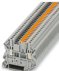
Morsetto con sezionatore a coltello, con sezionatore a coltello ruotato di 180°, connessione: a vite, sezione: 0,14 mm<sup>2</sup> - 4 mm<sup>2</sup>, AWG: 26 - 12, larghezza: 5,2 mm, colore: grigio, montaggio: NS 35/7,5, NS 35/15
