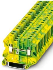
Morsetti comp. per conduttori terra, tipo di connessione: Connessione a vite, sezione: 0,14 mm<sup>2</sup> - 6 mm<sup>2</sup>, montaggio: NS 35/7,5, NS 35/15, colore: giallo-verde
