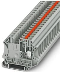
Morsetto con sezionatore a coltello, con linguetta di azionamento, tensione nominale: 500 V, corrente nominale: 20 A, tipo di connessione: Connessione a vite, Sezione di dimensionamento: 6 mm<sup>2</sup>, sezione: 0,2 mm<sup>2</sup> - 10 mm<sup>2</sup>, montaggio: NS 35/7,5, NS 35/15, colore: grigio
