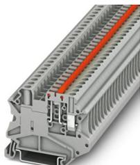
Morsetto con sezionatore a coltello, con linguetta di azionamento, tensione nominale: 500 V, corrente nominale: 20 A, tipo di connessione: Connessione a vite, Sezione di dimensionamento: 2,5 mm<sup>2</sup>, sezione: 0,14 mm<sup>2</sup> - 6 mm<sup>2</sup>, montaggio: NS 35/7,5, NS 35/15, colore: grigio
