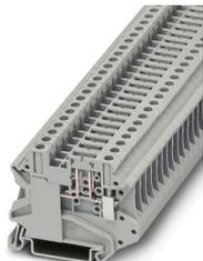
Morsetto sezionatore, Corrente e tensione sono determinate dalla spina impiegata., tensione nominale: 500 V, Corrente continua termica  $I_{th}$ : 20 A, tipo di connessione: Connessione a vite, Sezione di dimensionamento: 4 mm<sup>2</sup>, sezione: 0,14 mm<sup>2</sup> - 6 mm<sup>2</sup>, montaggio: NS 35/7,5, NS 35/15, colore: grigio
