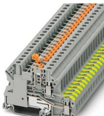
Morsetto passante, con viti per prese di prova per l'alloggiamento di spine di prova, tensione nominale: 500 V, corrente nominale: 20 A, tipo di connessione: Connessione a vite, Sezione di dimensionamento: 2,5 mm<sup>2</sup>, sezione: 0,14 mm<sup>2</sup> - 6 mm<sup>2</sup>, montaggio: NS 35/7,5, NS 35/15, colore: grigio
