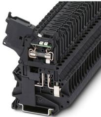
Morsetto portafusibili, tipo di fusibile: Vetro / ceramica / ..., tipo fusibile: G / 5 x 20, tensione nominale: 24 V, corrente nominale: 6,3 A, tipo di connessione: Connessione a vite, Sezione di dimensionamento: 4 mm<sup>2</sup>, sezione: 0,14 mm<sup>2</sup>- 6 mm<sup>2</sup>, tipo di montaggio: NS 35/7,5, NS 35/15, colore: nero
