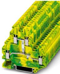
Morsetti comp. per conduttori terra, numero di connessioni: 4, tipo di connessione: Connessione a vite, sezione: 0,14 mm<sup>2</sup> - 6 mm<sup>2</sup>, tipo di montaggio: NS 35/7,5, NS 35/15, colore: giallo-verde
