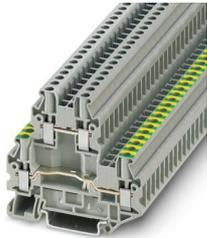
Morsetto a più piani, tensione nominale: 800 V, corrente nominale: 30 A, tipo di connessione: Connessione a vite, Sezione di dimensionamento: 4 mm<sup>2</sup>, sezione: 0,14 mm<sup>2</sup> - 6 mm<sup>2</sup>, tipo di montaggio: NS 35/7,5, NS 35/15, colore: grigio
