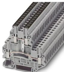
Morsetto a due piani, con ripartitore di potenziale, tensione nominale: 800 V, corrente nominale: 30 A, tipo di connessione: Connessione a vite, Sezione di dimensionamento: 4 mm<sup>2</sup>, sezione: 0,14 mm<sup>2</sup> - 6 mm<sup>2</sup>, tipo di montaggio: NS 35/7,5, NS 35/15, colore: grigio
