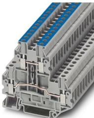
Morsetto a due piani, tensione nominale: 500 V, corrente nominale: 24 A, tipo di connessione: Connessione a vite, Sezione di dimensionamento: 2,5 mm<sup>2</sup>, sezione: 0,14 mm<sup>2</sup> - 4 mm<sup>2</sup>, tipo di montaggio: NS 35/7,5, NS 35/15, colore: grigio
