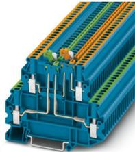
Morsetto con sezionatore a coltello, tensione nominale: 400 V, corrente nominale: 16 A, tipo di connessione: Connessione a vite, Sezione di dimensionamento: 2,5 mm<sup>2</sup>, sezione: 0,14 mm<sup>2</sup> - 4 mm<sup>2</sup>, tipo di connessione: Connessione a vite, Sezione di dimensionamento: 2,5 mm<sup>2</sup>, sezione: 0,14 mm<sup>2</sup> - 4 mm<sup>2</sup>, montaggio: NS 35/7,5, NS 35/15, colore: blu
