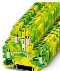
Morsetto a due piani per conduttori di terra, numero di connessioni: 4, tipo di connessione: Connessione a vite, sezione: 0,14 mm<sup>2</sup> - 4 mm<sup>2</sup>, tipo di montaggio: NS 35/7,5, NS 35/15, colore: giallo-verde
