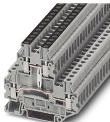
Morsetto a due piani, con ripartitore di potenziale, tensione nominale: 500 V, corrente nominale: 24 A, tipo di connessione: Connessione a vite, Sezione di dimensionamento: 2,5 mm<sup>2</sup>, sezione: 0,14 mm<sup>2</sup> - 4 mm<sup>2</sup>, tipo di montaggio: NS 35/7,5, NS 35/15, colore: grigio
