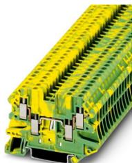
Morsetti comp. per conduttori terra, numero di connessioni: 4, tipo di connessione: Connessione a vite, sezione: 0,14 mm<sup>2</sup> - 4 mm<sup>2</sup>, tipo di montaggio: NS 35/7,5, NS 35/15, colore: giallo-verde
