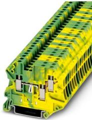
Morsetti comp. per conduttori terra, numero di connessioni: 3, tipo di connessione: Connessione a vite, 1. piano, sezione: 0,14 mm<sup>2</sup> - 4 mm<sup>2</sup>, tipo di montaggio: NS 35/7,5, NS 35/15, colore: giallo-verde
