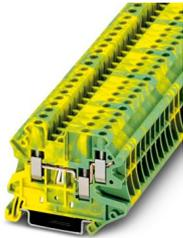
Morsetti comp. per conduttori terra, numero di connessioni: 3, tipo di connessione: Connessione a vite, 1. piano, sezione: 0,14 mm<sup>2</sup> - 6 mm<sup>2</sup>, tipo di montaggio: NS 35/7,5, NS 35/15, colore: giallo-verde
