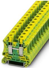
Morsetti comp. per conduttori terra, numero di connessioni: 2, tipo di connessione: Connessione a vite, Sezione di dimensionamento: 10 mm<sup>2</sup>, sezione: 0,5 mm<sup>2</sup> - 16 mm<sup>2</sup>, tipo di montaggio: NS 35/7,5, NS 35/15, colore: giallo-verde
