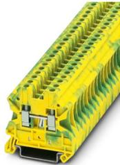
Morsetti comp. per conduttori terra, numero di connessioni: 2, tipo di connessione: Connessione a vite, sezione: 0,14 mm<sup>2</sup> - 6 mm<sup>2</sup>, tipo di montaggio: NS 35/7,5, NS 35/15, colore: giallo-verde
