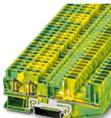
Morsetto a molla per conduttori di terra, numero di connessioni: 4, tipo di connessione: Connessione a molla/a innesto, 1. piano, collegamento a destra, sezione: 0,08 mm<sup>2</sup> - 6 mm<sup>2</sup>, tipo di montaggio: NS 35/7,5, NS 35/15, colore: giallo-verde
