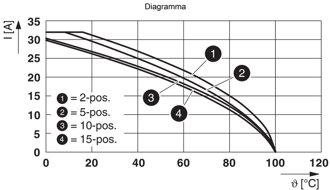
Curva derating per morsetti a molla ST 4/1P.. e ST 4/2p.. con tutte le versioni di connettore SP4/... . Le curve derating si determina moltiplicando i valori delle curve base per il fattore 0,8.
