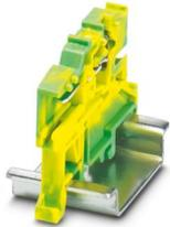
Giunto COMBI, tensione nominale: 500 V, corrente nominale: 24 A, numero di connessioni: 1, numero poli: 1, tipo di connessione: Connessione a molla, Sezione di dimensionamento: 2,5 mm<sup>2</sup>, sezione: 0,08 mm<sup>2</sup> - 4 mm<sup>2</sup>, tipo di montaggio: NS 35/7,5, NS 35/15, colore: giallo/verde
