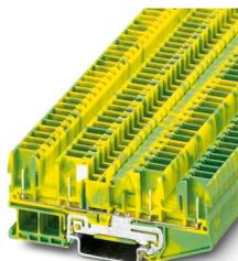
Morsetto a molla per conduttori di terra, numero di connessioni: 4, tipo di connessione: Attacco connettore, 1. piano, sezione: 0,08 mm<sup>2</sup> - 4 mm<sup>2</sup>, tipo di montaggio: NS 35/7,5, NS 35/15, colore: giallo-verde
